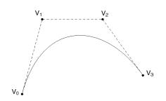
$$Q''(t) = \begin{bmatrix} 6t & 2 & 0 & 0 \end{bmatrix} \begin{bmatrix} -1 & 3 & -3 & 1 \\ 3 & -6 & 3 & \\ -3 & 3 & & \\ 1 & & & \end{bmatrix} \begin{bmatrix} V_0 \\ V_1 \\ V_2 \\ V_3 \end{bmatrix}$$
