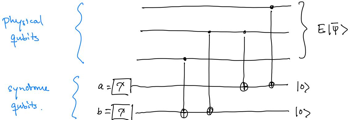
If run on  $|x, y, z\rangle$ , then  $a = x \oplus y$ ,  $b = y \oplus z$ .
