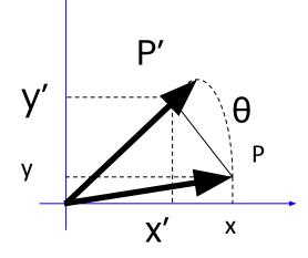
$$\begin{bmatrix} x' \\ y' \end{bmatrix} = \begin{bmatrix} \cos\theta & -\sin\theta \\ \sin\theta & \cos\theta \end{bmatrix} \begin{bmatrix} x \\ y \end{bmatrix}$$
