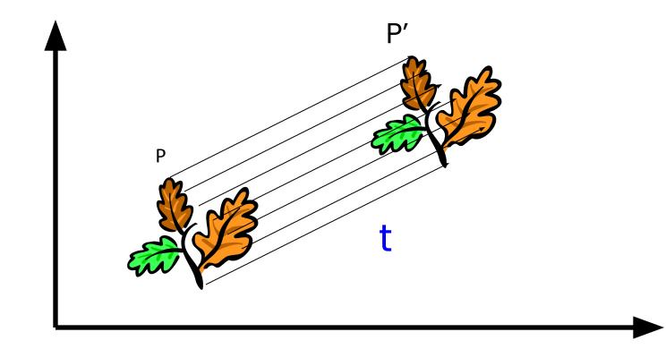
$\mathbf{P} = (x, y) \to (x, y, 1)$  $\mathbf{t} = (t_x, t_y) \to (t_x, t_y, 1)$ P′ ty Ρ Ρ y  $\mathbf{P'} \rightarrow \begin{bmatrix} x + t_x \\ y + t_y \\ 1 \end{bmatrix} = \begin{bmatrix} 1 \end{bmatrix}$ tx Х ·y
