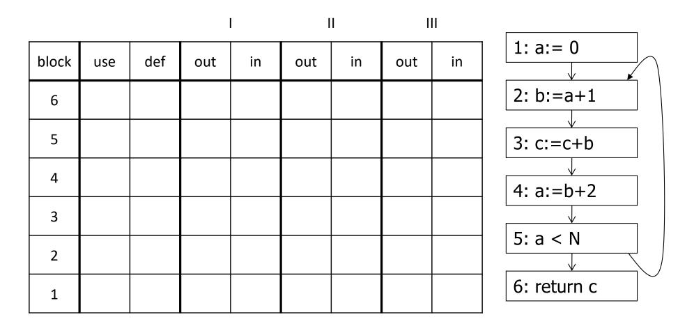
$in[b] = use[b] \cup (out[b] - def[b])$  $out[b] = \bigcup_{s \in succ[b]} in[s]$
