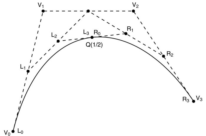
DisplayBezier(  $V_0, V_1, V_2, V_3$  )
