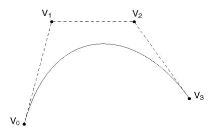
$$Q''(t) = \begin{bmatrix} 6t & 2 & 0 & 0 \end{bmatrix} \begin{bmatrix} -1 & 3 & -3 & 1 \\ 3 & -6 & 3 \\ -3 & 3 & \end{bmatrix} \begin{bmatrix} V_0 \\ V_1 \\ V_2 \\ V_3 \end{bmatrix}$$
